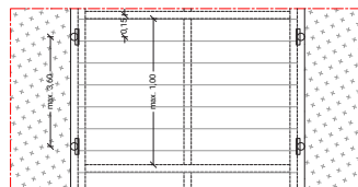
S07.2 (Detail de principe Boardwalk type 2: sections larges > 0.90 m à 1.50 m 1:20
